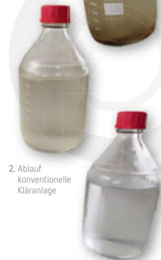
3. Ablauf Kläranlage mit 4. Reinigungsstufe (Ozonung)
