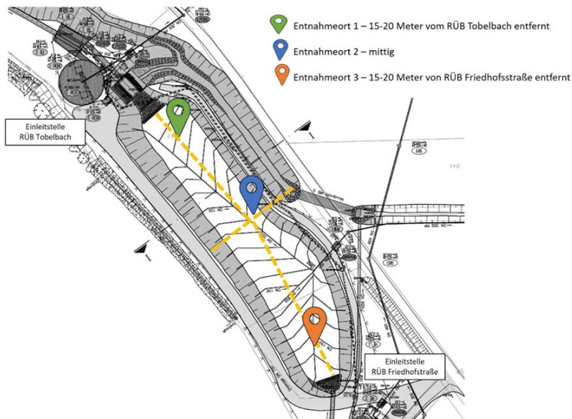
Abbildung 4.5: Entnahmestort der Bodenproben der RBF Tobelbach (Darstellung auf Basis Wasser-Müller Ingenieurbüro GmbH 2020)
