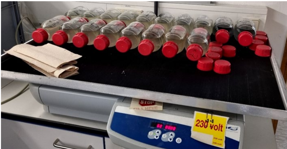
Abbildung 6.1: Schüttelversuche - Versuchsaufbau (Horizontalschüttler)
