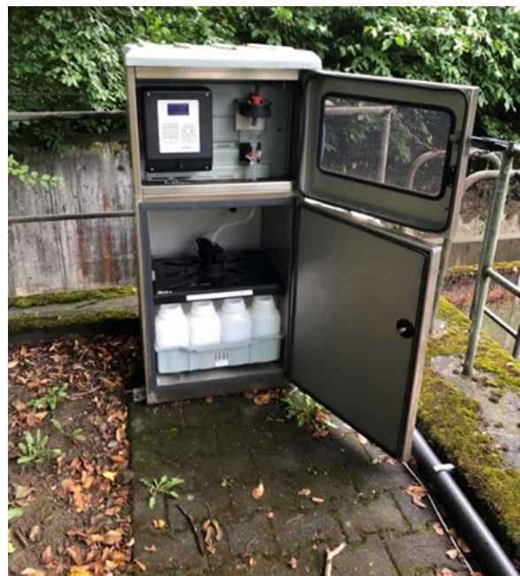
Abbildung 4.4: MAXX Probenehmer mit Flaschenrack, RÜB Langenargener Straße (eigene Aufnahme)
