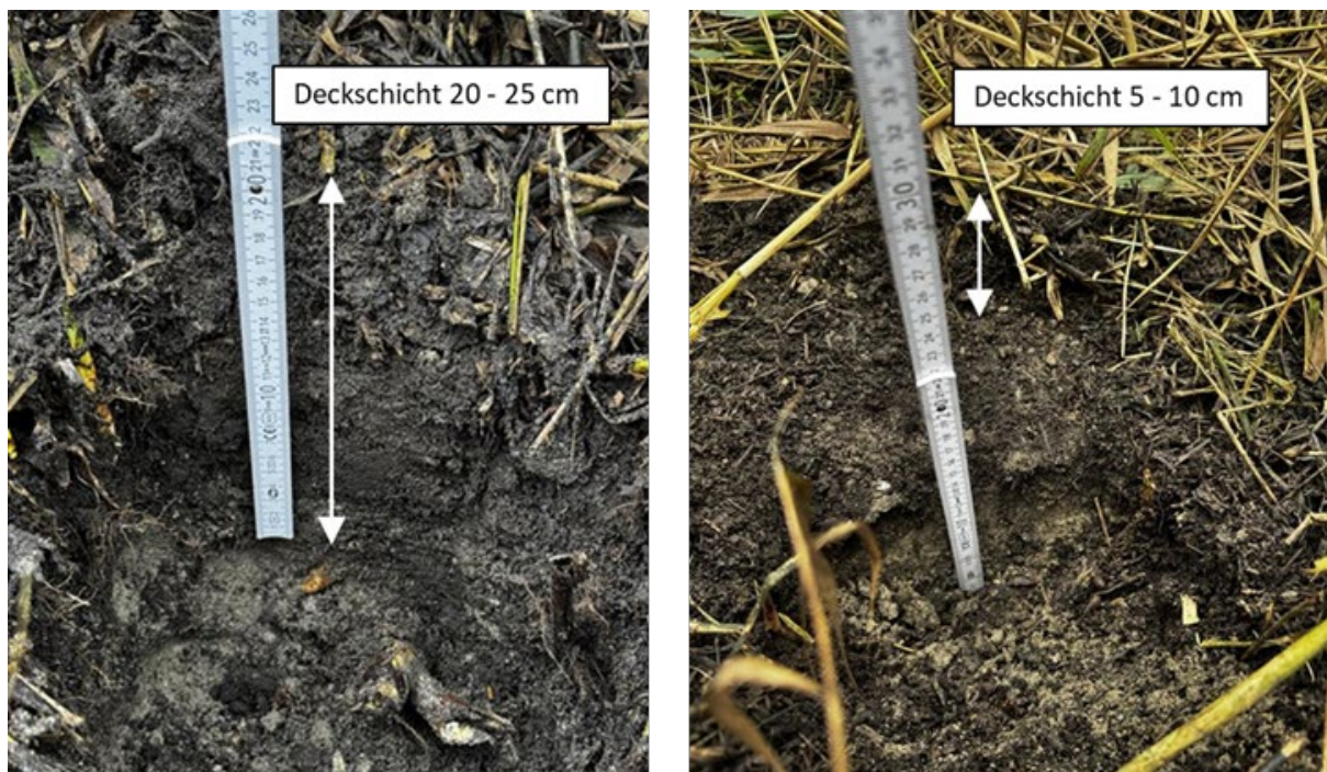
Abbildung 2.7: Deckschichthöhen im Zuflussbereich des RÜB Tobelbach (links) und RÜB Friedhofstraße (rechts) (eigene Darstellung).
