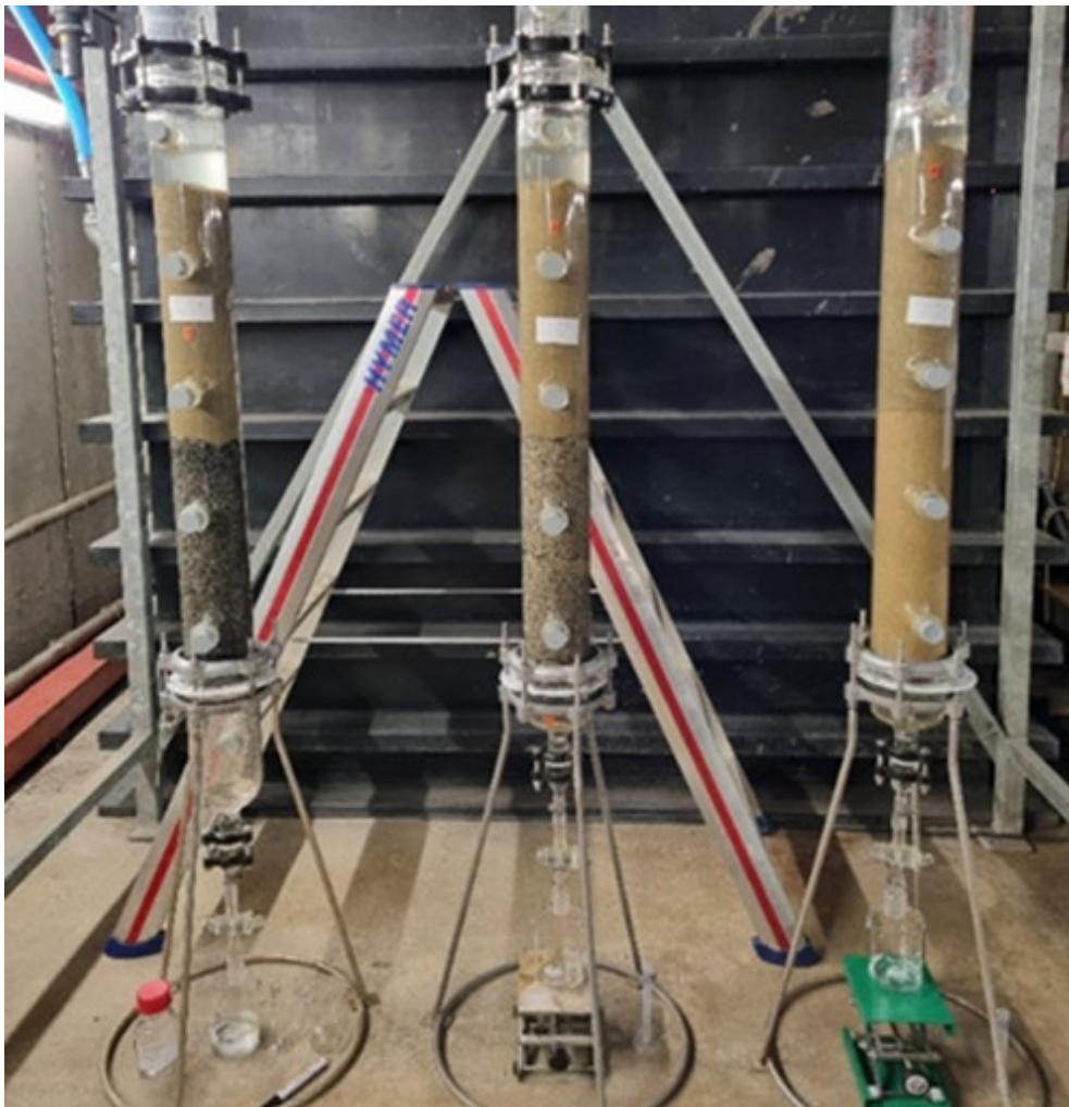
Abbildung 6.6: Säulenversuche - Versuchsaufbau (v.r.n.l.: Säule 1 bis 3)
