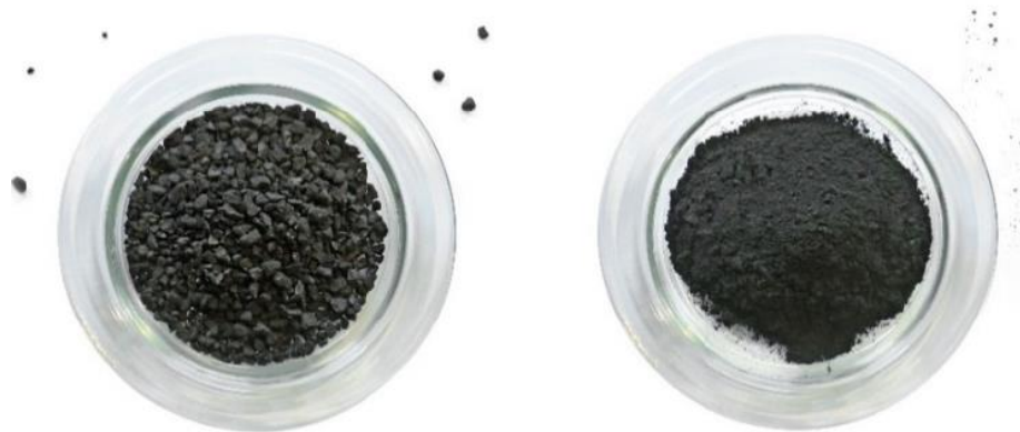
Abbildung 2-5: Visueller Vergleich von GAK (links) und PAK (rechts) (Ausschnitt aus DWA-AG KA-8.6, 2021)
