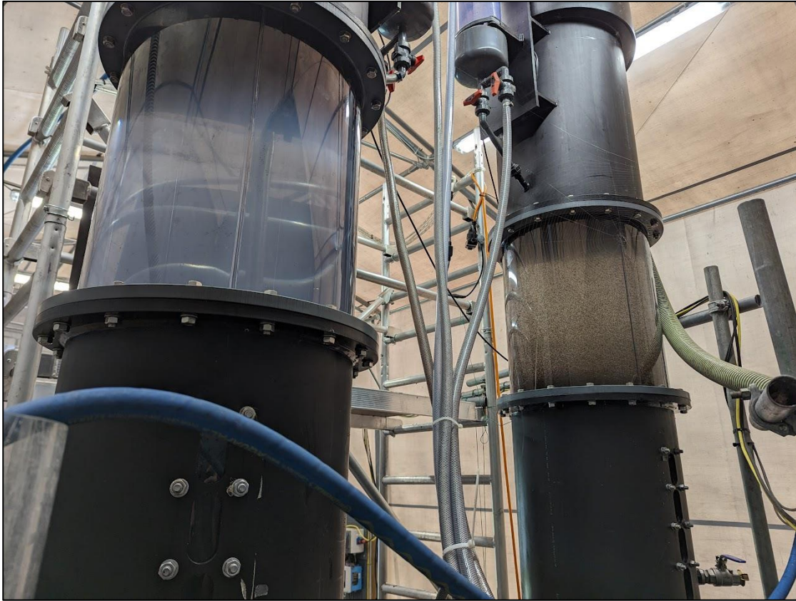
Abbildung 3-4: Eingebaute transparente Zwischenstücke als Sichtfenster nach dem Umbau
