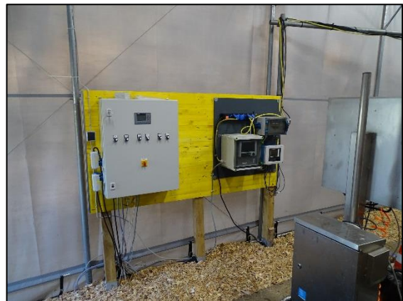
Abbildung 3-2: Abbildungen der halbtechnischen Versuchsanlage // oben links: Ansicht der Versuchsanlage // oben rechts: Zulaufleitungen zu den Reaktoren // unten links: Überlaufschwelle an der Oberkante eines Reaktors // unten rechts: Schaltschrank zur Steuerung der Pumpentechnik und Mehrkanal-Controller
