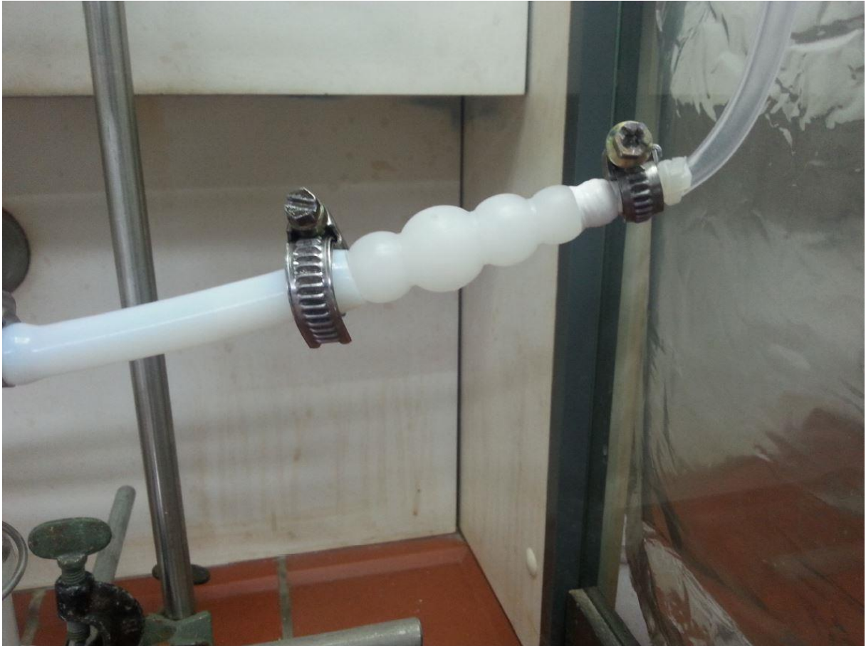
Abbildung 1-2: Verbindungsstück zwischen Schläuchen mit verschiedenen Durchmessern; Abgedichtet mit Teflonband und mit einer Metallschelle befestigt
