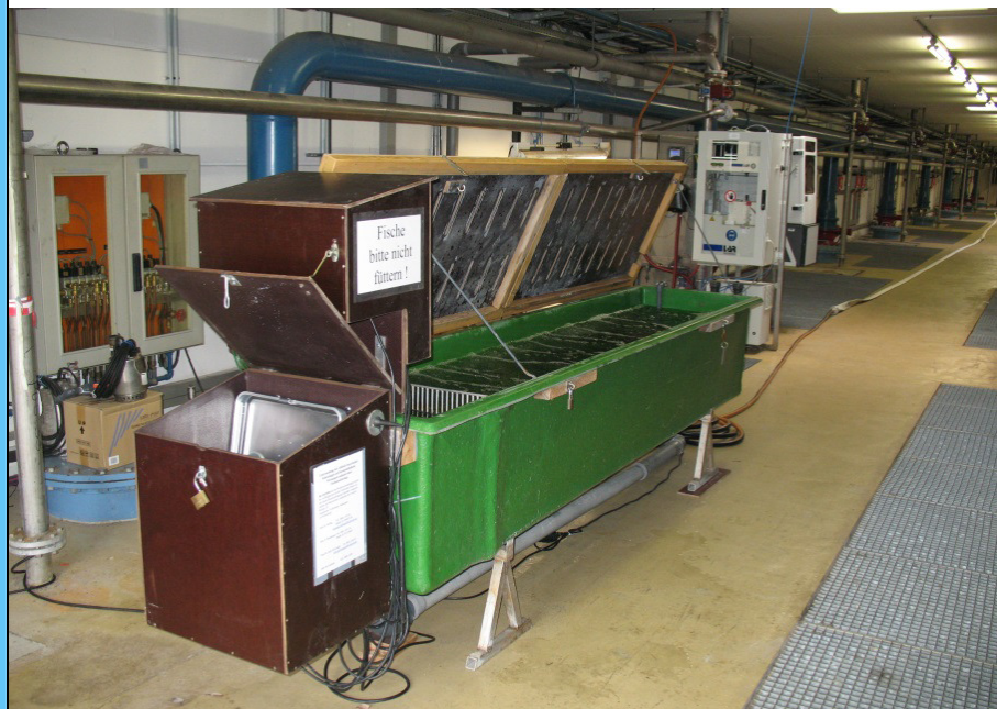
Bild 2: Langstromrinne zur Fischexposition mit Online-Messsonden auf dem Gelände des Klärwerks Mannheim (Bildquelle: H. Ferling, LfU)
