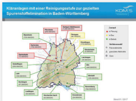
Kläranlagenkarte zur Spurenstoffelimination
