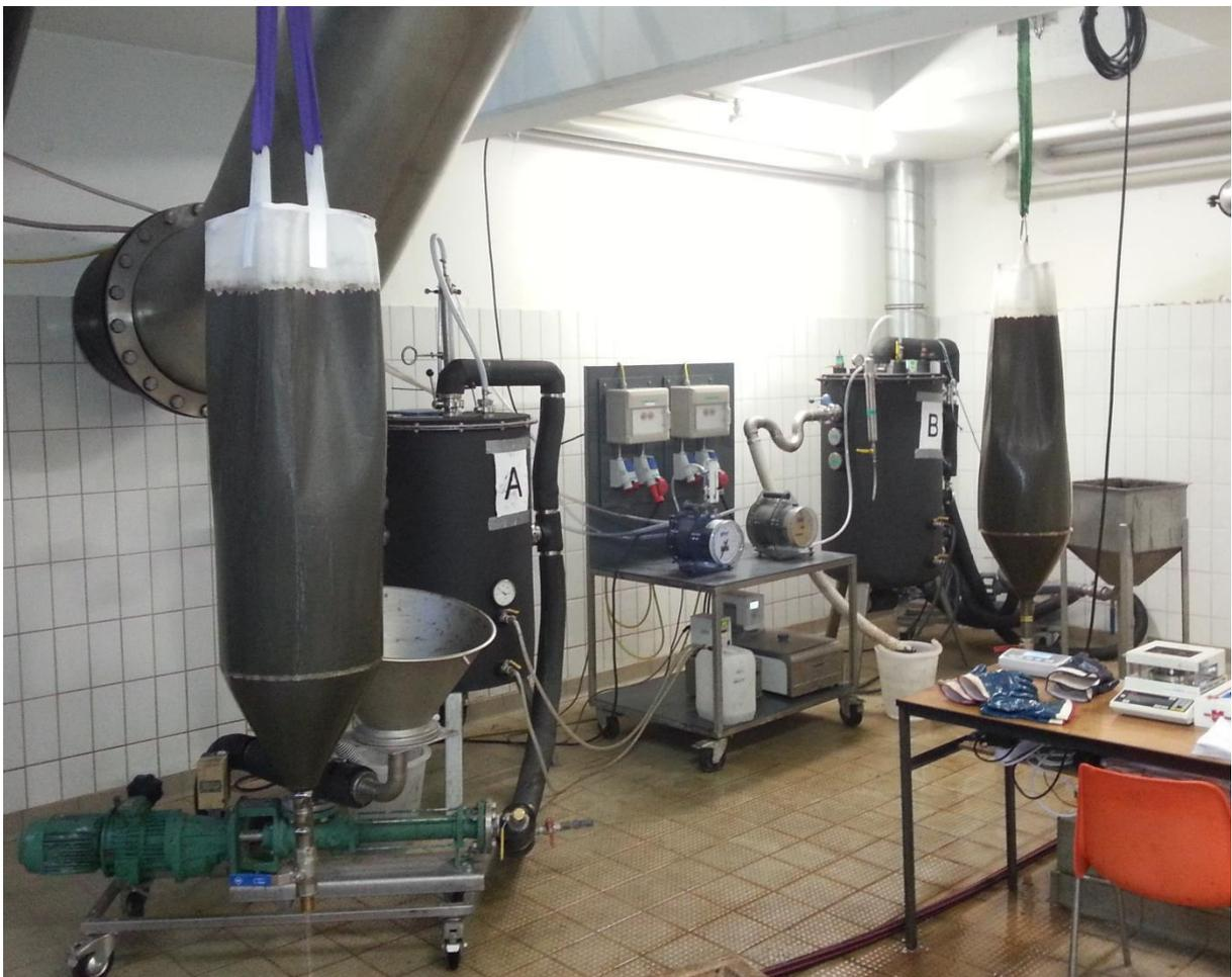
Abbildung 2-2: Eindickung der Rohschlämme mit Hilfe von "Abtrennsäcken"
